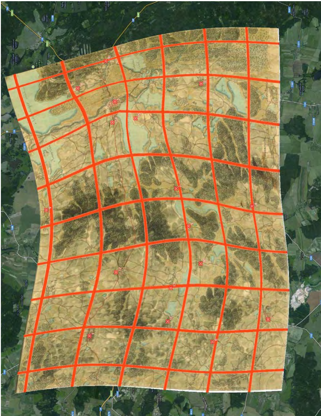
Obr. č. 14. Georeferencovaná sekce 251 I. vojenského mapování. Křížkem a číslem jsou označeny identické body. Do obrazu sekce byla před transformací přidána pravidelná čtvercová síť, která po transformaci názorněji ilustruje míru deformace v různých částech sekce. Velká lokální deformace je vidět v části na východ od Třeboně, která je způsobena chybným zakreslením celé oblasti. Cesta od Hradecké brány je na sekci zakreslena směrem na východ, ale ve skutečnosti vede směrem severovýchodním. Taková deformace v přehledném terénu s dostatkem dobře viditelných bodů ukazuje spíše na záměrnou lokální deformaci, která vznikla při sestavování sekce, aby kresba v hrubých rysech navazovala na okolní mapové sekce.
