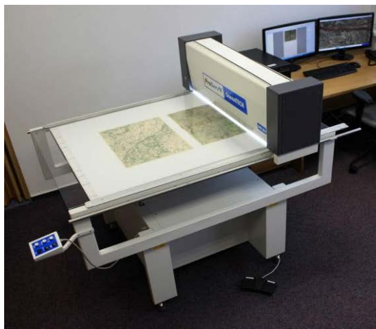
Obr. 1 - Kartometrický skener ScannTech 800 a vpravo integrovaná kolébka pro digitalizaci atlasů
