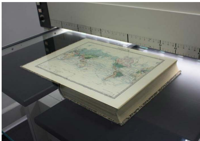
Obr. 1 - Kartometrický skener ScannTech 800 a vpravo integrovaná kolébka pro digitalizaci atlasů
