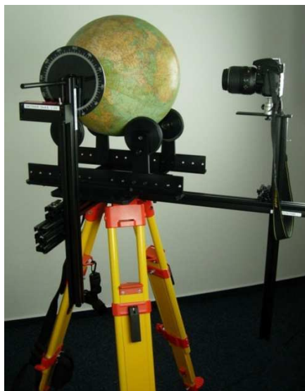
Obr. 2: Digitalizační zařízení pro snímání glóbů
